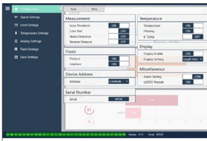
Fig. 6: La pestaña de configuración permite que el transmisor de nivel se configure para la aplicación específica.
